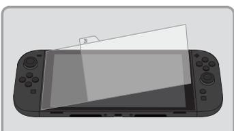
3 Sørg for at skjærmbeskytteren er helt rett i forhold til kantene på Nintendo Switch 2-berøringskærmen. Legg den ned på skjærmen, og glatt ut de festede områdene med rengjøringskluten for å forhindre at luftbobler fanges mellom skjærmen og skjærmbeskytteren. Dra av resten av beskyttelsesfilmen, og påfør den andre halvdel av skjærmbeskytteren, som beskrevet ovenfor.
